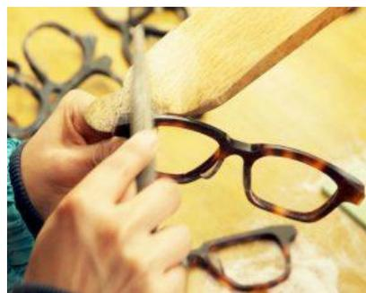
写真②仕上げにふちを磨く工程は、職人の手作業である。
