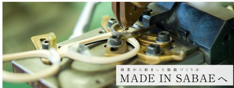
写真①現在の鯖江のメガネ工場の様子。精巧な機械により、高品質なメガネを作り続ける。
