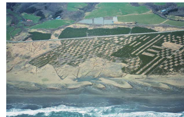
格子状に見えるベルトユニット工法。緑色の部分がクロマツ、白く見える部分はカシワの植栽地。並行して排水用の側溝を掘る作業も進めていた。
