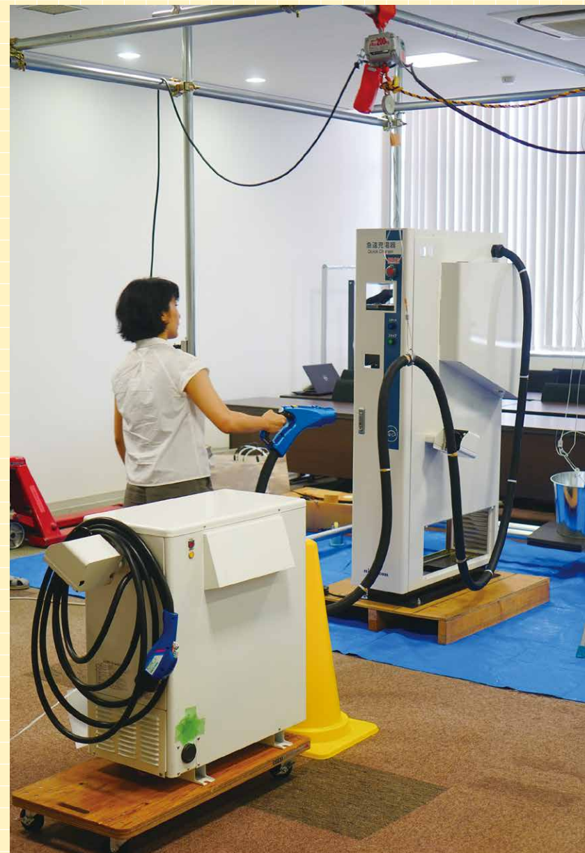
急速充電器のプロトタイプを実際に試している様子。ケーブルを上からつり下げた場合、どの程度重量を感じづらくなるのか、檜垣さんが実際に確かめている。
