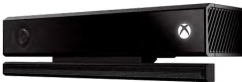
「Xbox One Kinect センサー」。初代「Xbox 360 Kinect」と比べ、音声認識、画像認識、モーション検知がより高感度になり、繊細な動きに対応する。
