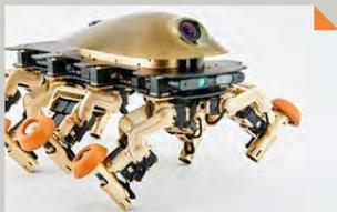
移動ロボットの可能性を追求した「未来の乗り物」のコンセプトモデル。人工知能を搭載した8本の足が、環境に応じて「車輪」モードと「脚歩行」モードに切り替わる。坂道や段差などの悪路も水平のまま移動する。
