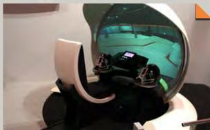
高機能なロボットを、複雑な操作をなくし、直観的に操作するために開発されたコックピットシステム。福祉機器や未来の乗り物など、実現の可能性が高い「ロボットの遠隔操作」に不可欠な技術。
