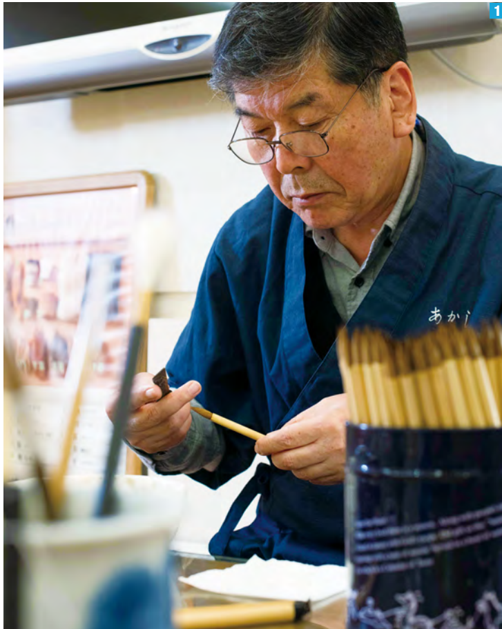
1 奈良筆の伝統工芸士、松谷文夫さん。当日は、筆に糸を巻き、余分な布海苔(ふのり)を絞り出す作業中。形を整えて乾燥させる仕上げの段階に。2 作業場には、山羊のはく製が。最も高級な筆は、山羊の獣毛を使用。しかし、低価格の筆にも山羊を。体毛の部位によって価格が大きく違ってくるといいます。ちなみに、大きな筆のほとんどは、長さのある馬の毛を使います。
