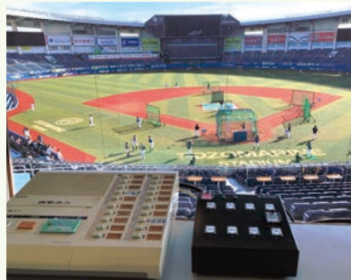
▲ 左は音響機器で、試合開始時間や投球数をマイクで放送する際に使います。右が判定機器で公式記録操作卓です。
