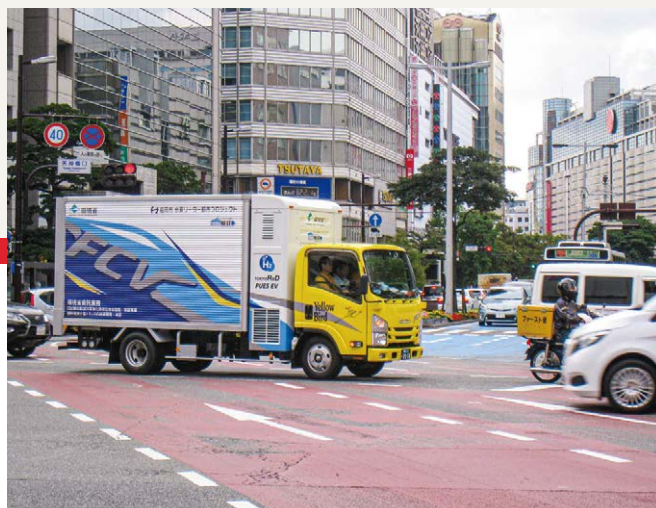
▲ 公道での実証実験中のFCトラック
