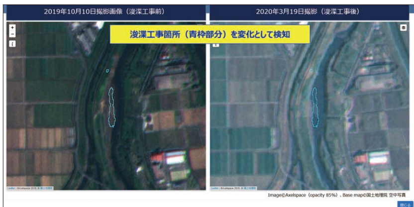
▲ 河川の土砂堆積監視(日野川の浚渫工事前後比較)
