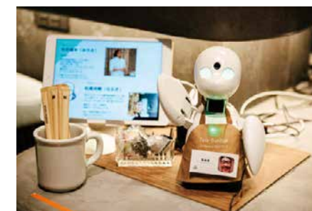
2・3上p.48-49「デザインのかでできること」 遠隔操作でコミュニケーションを可能とし、 さまざまな人の社会参画の可能性を広げる分身ロボット。
