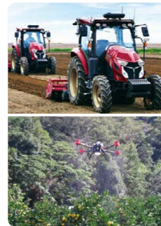
① ③人が乗る必要のないトラクター(上)と、ドローンによる葉の散布(下)
